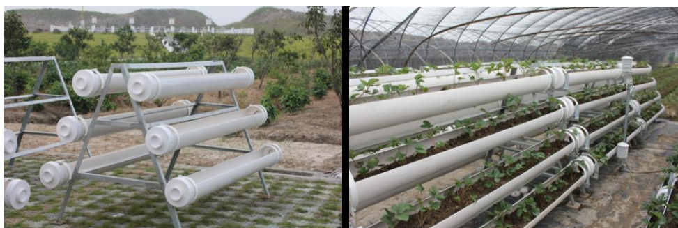
图 8、9 立体栽培槽架的设计焊制及仪器探头布置
